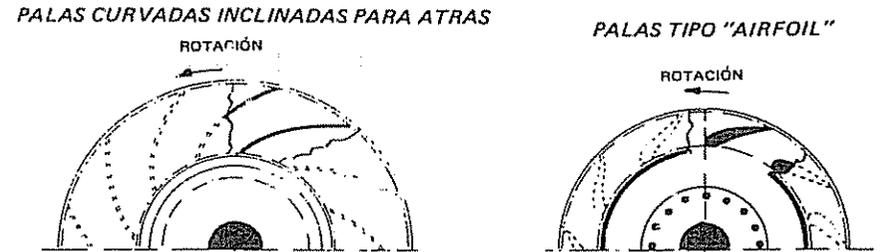
FIG. 16-VI. Tipos de palas de rotores de ventiladores centrífugos.
